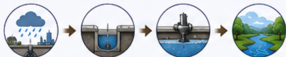
Starker Regen Kanal füllt sich schnell Wasserstand steigt über die Schwelle Überschuss wird in das Gewässer entlastet
